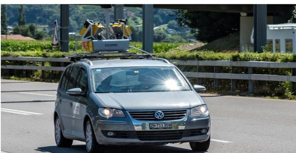
Système Mobilemapping embarqué sur véhicule
